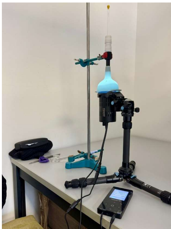
Slika 8. Aparatura za „off site“ osvjetljavanje uzoraka pomoću Kessil lampe PR160L- 370 nm
