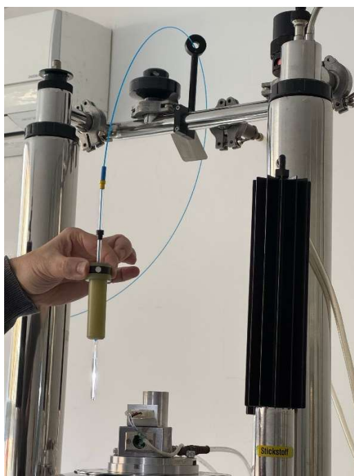
Slika 7. Prikaz optičkog vlakna koje se nalazi unutar NMR cjevčice s uzorkom
